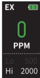
界面左上角显示检测气体名称为可燃气体（EX）；右上角显示电池电量及充电指示；中部显示当前浓度和单位；下部显示当前选择的报警灵敏度及对应的报警浓度值。
