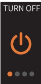
\*注：当设备无操作状态下5分钟会自动关机，按键操作或者设备报警会重置自动关机计时。当设备检测到电池电压过低会主动关机。
